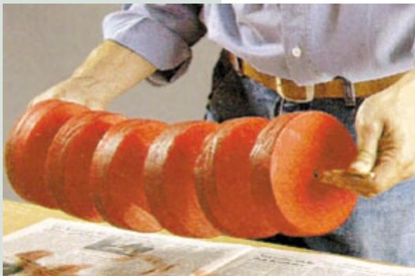
aufgedreht werden kann. Dann ein Rad mit U-Scheiben aufschieben und die Achse durch das Achs- bzw. Lenklager stecken. Auf der anderen Seite ebenfalls U-Scheiben und Rad aufstecken und die Markierung zum ablängen der Achse setzen. Wenn dann das zweite Gewinde geschnitten und auch dort die Hutmutter fest aufgedreht ist, muss zwischen Rädern und U-Scheiben ausreichend Spiel bleiben.
