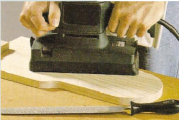
Die Kanten mit dem Schwingschleifer oder per Hand mit einem Schleifklotz glätten. Für alle gerundeten und geschweiften Formen ein extra schmales Kurvensägeblatt benutzen. Liegen alle Teile zugeschnitten auf Ihrem Werk Tisch, geht's an den Zusammenbau. Zuerst verleimt man die beiden Verstärkungen (4) miteinander und klebt sie dann unter die Sitzplatte (1). Die Rückwand (2)
