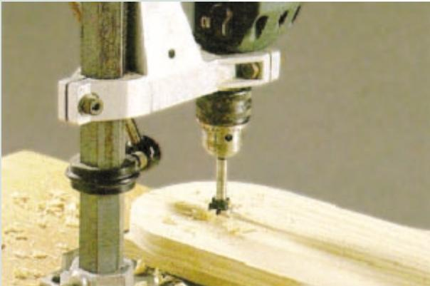
Beim Verschrauben der Bodenplatte (3) mit der Rückwand können die unten liegenden Schraubköpfe sichtbar bleiben. Wo die Spanplattenschrauben in Randnähe eingedreht werden, wie zum Beispiel bei den Achslagern (6), muss man zuerst vorbohren, damit das Holz nicht ausbricht. Zum Herstellen der verschiedenen Bohrungen für Lenkachse (10) und Radachsen ist ein
