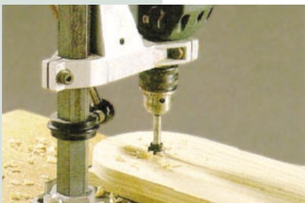
sterzante (10) e il volante è indispensabile un supporto a colonna. È necessario utilizzare soltanto punte di prima qualità per poter eseguire fori davvero puliti. Un trucco durante l'incollatura dei due dischi per ciascuna ruota: prima eseguire i fori, quindi spingere i dischi su uno degli assi e stringerli con i morsetti evitando che le due parti si spostino.
