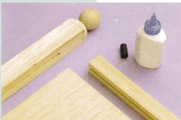
il materiale al di sopra dei semicerchi su ciascuno dei quattro lati del palo verrà rimosso fino ad un perfetto arrotondamento. Ora tagliare le otto assicelle del telaio e le quattro pareti laterali. Attaccare alla fresatrice verticale una fresa per scanalature da 6 mm. Nei pali e nelle assicelle del telaio viene fresata una scanalatura centrale, profonda 10 mm. In alto la distanza delle assicelle dall'estremità del palo è di 50 mm, in basso è di 20 mm.
