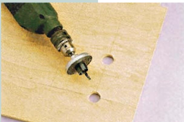
Pour cette raison, fraiser les fentes 2 à 3 mm plus profond. Il reste lors de l'assemblage assez de place pour la colle superflue. Les baguettes murales en alternance droites ou arrondies sont enduites au choix d'un glaçage de couleur comme les poteaux et sont vissées de l'intérieur avec les traverses en utilisant de la colle étanche à l'eau. Fixer les baguettes de support aux quatre
