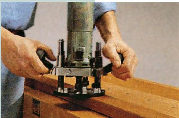
d'abord toutes les pièces droites à l'aide de la scie circulaire de table ou de la scie circulaire à main. Rectifier la forme souhaitée des dossiers (1) penchés vers l'arrière ainsi que des traverses (6) chantournées avec la scie à bande ou avec la scie sauteuse. Lorsque toutes les pièces sont préparées, utiliser la défonceuse sur poste fixe avec la fraise à feuilurer. Elle permet de découper les tenons dans le matériau. Vous trouverez les dimensions dans la liste de matériau.
