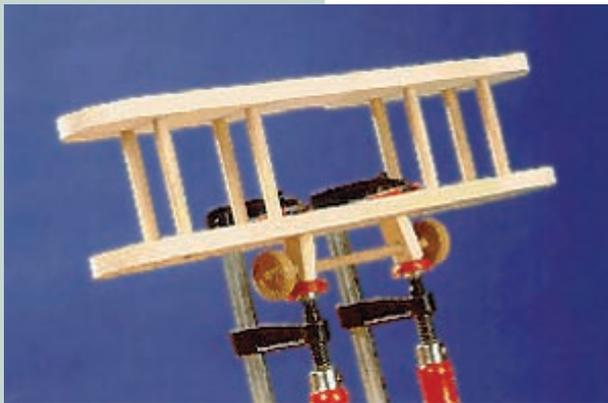
Sur le côté opposé du fuselage, effectuer un trou borgne d'un diamètre de 30 mm et d'une profondeur de 20 mm au milieu de l'enfilade des arêtes arrière du montant de l'aile. Ce perçage représente la place du pilote.
