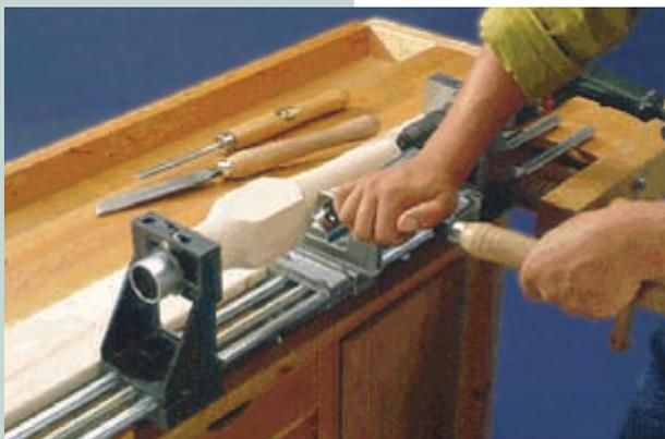
On commence avec la construction du fuselage. Un bois carré de 60x60 mm est rectifié au tour pour former à l'avant une diminution sur une longueur de 50 mm. 70 mm du bois carré restent et la partie arrière est également rectifiée au tour avec une légère diminution. Il est possible de représenter le moteur à l'avant du biplan avec une encoche correspondante.
