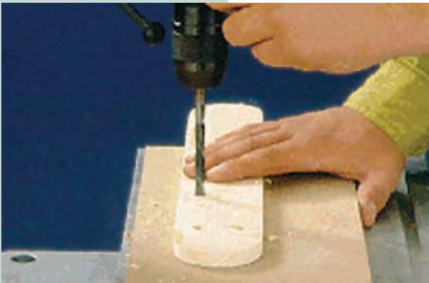
Préparer alors le fuselage pour pouvoir l'assembler aux montants des ailes.
