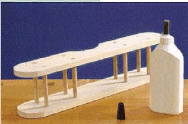
Sur un côté du morceau de bois coupé restant, scier un évidement d'une largeur de 60 mm et d'une profondeur de 10 mm dans lequel le montant inférieur de l'aile est collé.
