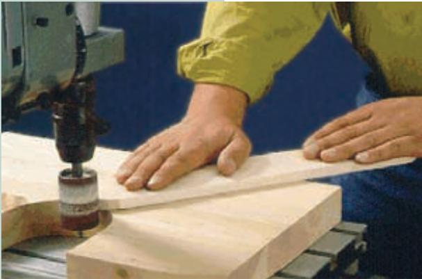
Percer ensuite les trous à l'aide du support de perçage pour le logement des montants d'ailes. Lorsque les deux ailes sont collées aux huit montants d'ailes, construire le train d'atterrissage et le coller en dessous et au milieu.
