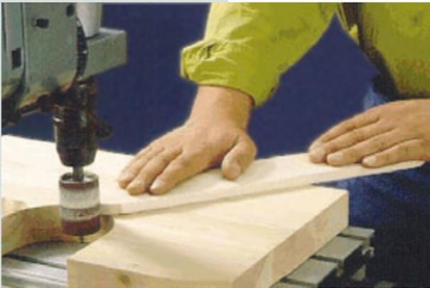
Anschließend fertigt man mit Hilfe des Bohrständers die Löcher zur Aufnahme der Tragflächenstreben. Sind die beiden Tragflächen mit den insgesamt acht Tragflächenstreben verleimt, stellt man das Fahrwerk her und leimt es mittig darunter.
