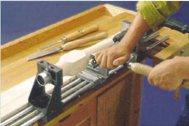
Ein Kantholz von 60 x 60 mm wird so abgedreht, dass vorn auf 50 mm Länge eine Verjüngung entsteht. 70 mm des Kantholzes bleiben stehen, und der hintere Teil wird ebenfalls mit einer leichten Verjüngung abgedreht. Vorn kann man den Motor des Doppeldeckers noch durch eine entsprechende Kerbung andeuten.
