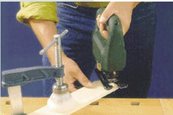
Für diese leichten Drechselarbeiten muss man nicht unbedingt eine große Drehbank besitzen. Hier reichen durchaus Drechsel-einrichtungen, die mit der Bohrmaschine angetrieben werden können. Ist der Rumpf soweit vorbereitet, folgt das Ausschneiden der Tragflächen. Für die Rundungen wird die Stichsäge mit Kurvensägeblatt eingesetzt.
