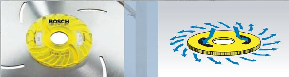
Der Luftstrom wird durch die Kanäle gleichmäßig auf die rotierende Scheibe geleitet. Die Diamanttrennscheibe wird dadurch wirksam gekühlt und die Laufruhe verbessert. Zudem absorbiert das Kühlelement mit Vibrationsdämpfung wegen seiner besonderen Materialeigenschaften die beim Arbeiten entstehenden Vibrationen.
