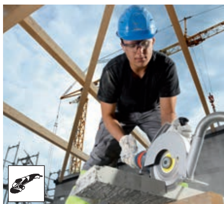
Резка с использованием алмазных отрезных кругов
