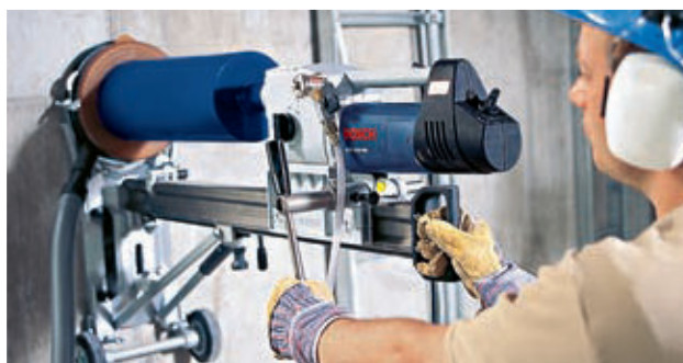
Găurire umedă sistematică: mașina Bosch de găurit cu diamant GDB 2500 WE, carote diamantate, suport de găurit S 500 A, dispozitiv de aspirare și aspirator universal.
