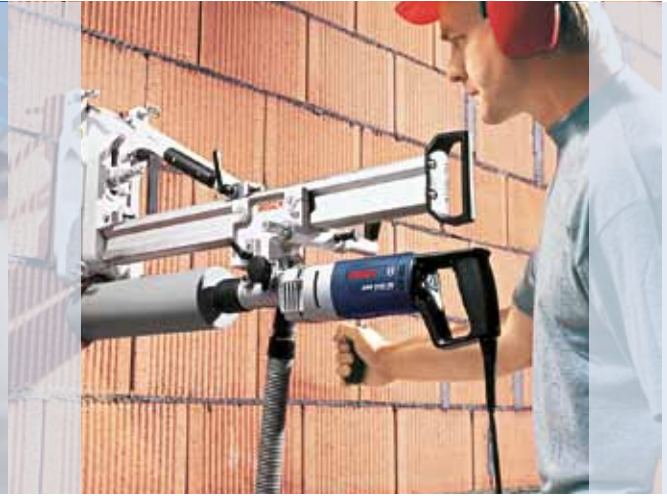
Un forage à sec précis : appareil de forage diamant Bosch GDB 1600 DE, travail sans percussion, stationnaire, par guidage manuel (avec aspiration).
