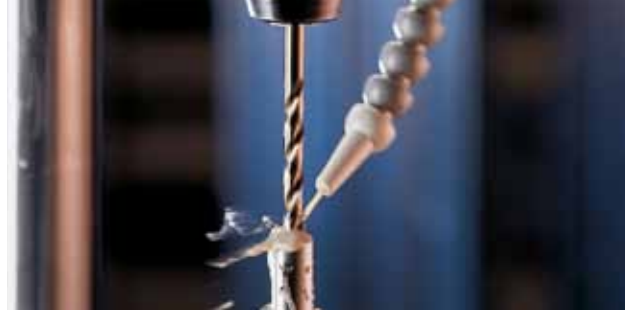
Perçage dans l'acier au chrome-nickel, de préférence avec perceuse à colonne et fluide de refroidissement
