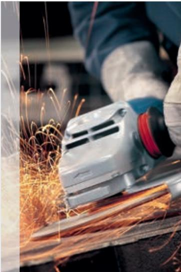
Bosch Trennscheiben bieten hohe Standzeiten und schnellen Arbeitsfortschritt. Der Einsatzbereich liegt je nach Ausführung beim Trennen von Werkstücken aus Metall, Stein und Inox.
