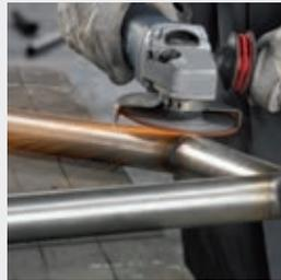
Kühler Schliff, verbesserte Spanabfuhr und weniger Verfärbung der Oberflächen: das spezielle Waffel-Design macht es möglich.
