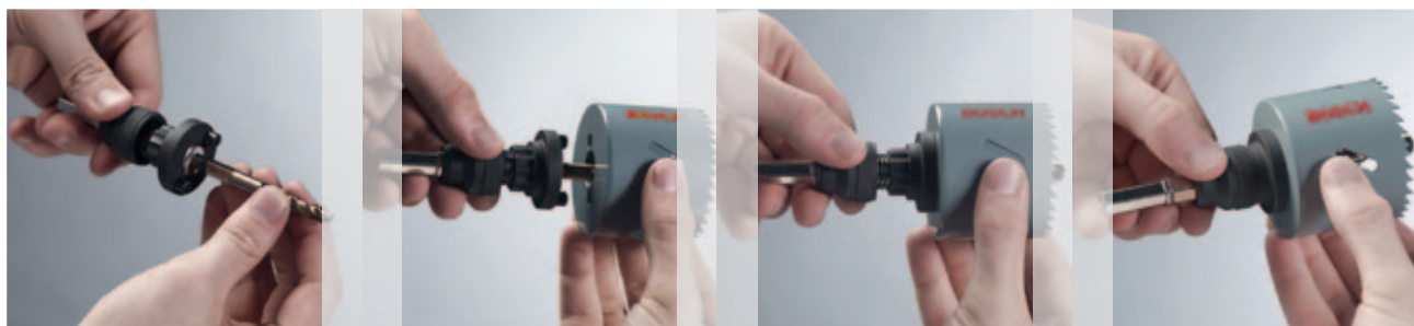
Insertion du foret de centrage
