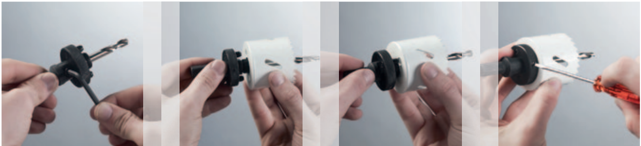
Einsetzen des Zentrierbohrers. Befestigen mit Innensechskantschraube.
