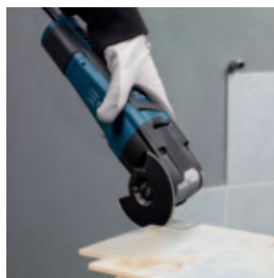
Präzises Schneiden von kleineren Ausschnitten in weichen Wandfliesen
